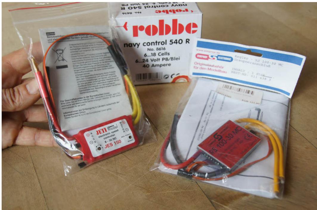
Im Gegensatz zu den Vier- Quadranten- Reglern decken die Modellbau- Regler immer nur 2 Quadranten ab. Das heißt, man hat entweder eine eingebaute Bremse und muß eine Relaisschaltung zur Fahrtrichtungsumkehr ergänzen. Oder man hat Fahrt vorwärts/ Fahrt rückwärts und muß eine Widerstandsbremse dazustellen. Beides ist kein Problem. Bezüglich der Bremse ist außerdem anzumerken, daß schwere Publikumzüge ohnehin über eine durchgehende **mechanische Anlage** zum Verzögern verfügen sollten!
