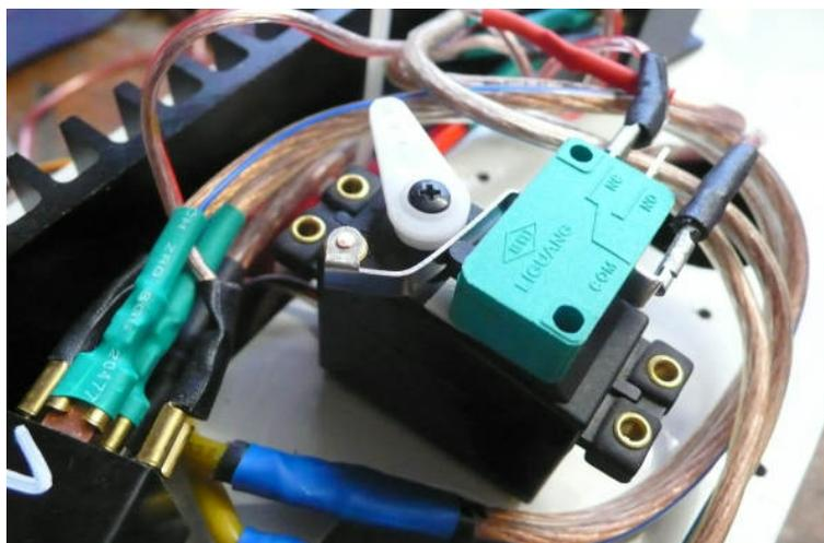
Der Robbe Schiffsregler navy control 540 R mit 40 A bietet sich besonders für einfach gebaute, preiswerte, leichtere Triebfahrzeuge an. Seine Leistung reicht aus, um auch eine Antriebsanlage bis 750 W zu steuern. Zwei Scootermotoren zu 250 oder 300 W oder ein Bosch-Lüfter sind also kein Problem. Und man kann damit auch schon ganz schön was bewegen! Die fehlende elektrische Widerstands-Bremse kann man sich mit einfachen Mitteln selbst bauen. Dazu ein kleines Experiment:
