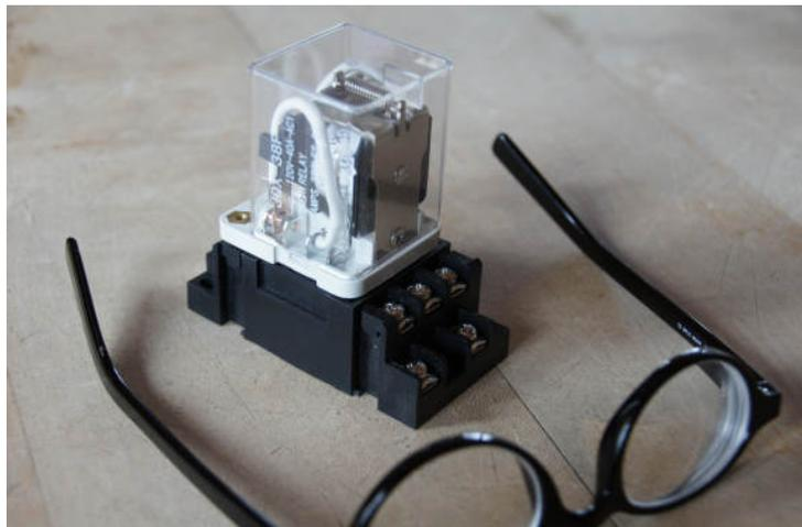
Die Betätigung des Relais- Schaltstroms wiederum geschieht entweder durch Handknopf- Schalter oder bei Fernsteuer-betrieb durch ein Servo mit angeflanschem Taster:
