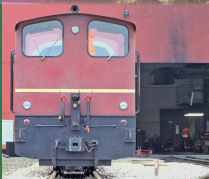
Maximaler Lokaufbau auf minimalem Gleis: die Diesellokomotive vom Typ V 22 der Jagstalbahn wurde von der Fa. Gmeinder/Mosbach als Derivat der Bundesbahn-Köf III in zwei Exemplaren geliefert. Man baute dort auch eine im Übrigen identische Industrielok mit Puffern und Hakenkupplung für Normalspur! Das niedrigere, flache Führerhaus der bekannten, weit verbreiteten Köf III-Typen war eine Vorgabe der DB, die ihre Kleinloks auf Flachwagen ins AW transportieren wollte!
